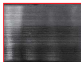
Dokładność powierzchni ścianki: wysokość nierówności= 18 \mu m
